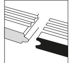
\*) Die Stirnkanten sind werkseitig imprägniert mit Stirnkantenversiegelung (Sikkens Kodrin WV 456).
